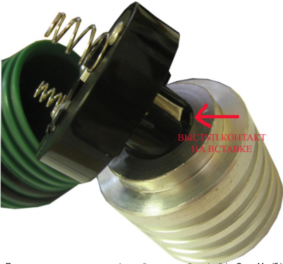
При установке светодиодного модуля для screw-in лампы Omer Moonlight обратить
