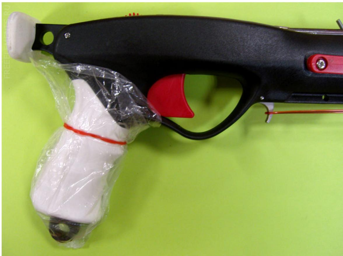
Триггерно-спусковое устройство, расположено в рукояти подводного ружья арбалета, выполняет функции надежной фиксации хвостовика гарпуна, удержания гарпуна и обеспечения выстрела путем нажатия на спусковой крючок, освобождение хвостовика гарпуна, его выстреливание под действием силы резиновых тяг, сброс монолиня.
