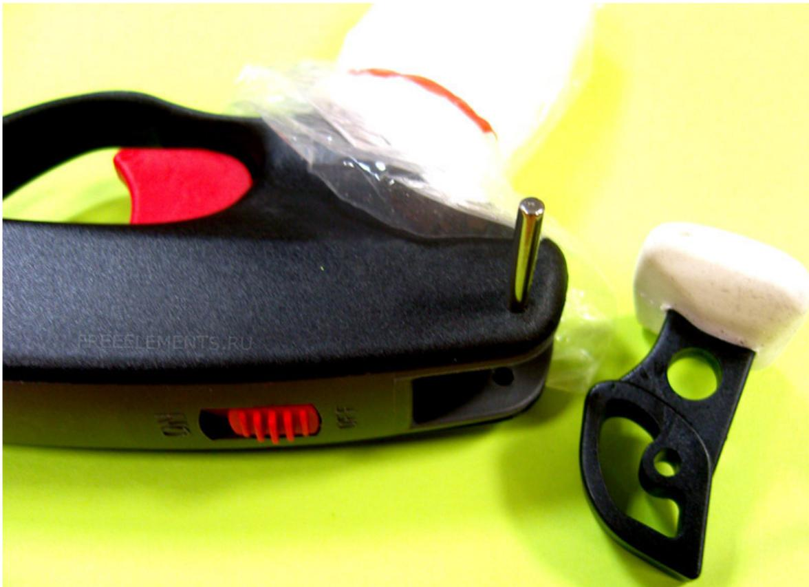
Для того чтобы разобрать триггер арбалета HammerHead Sperguns, необходимо снять триггер для демонтажа
