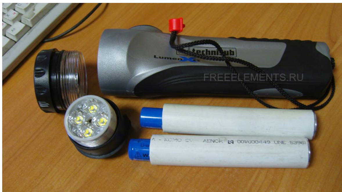
Для установки литиевых аккумуляторов 18650 в подводный фонарь Lumen X6 для использования со светодиодной головой для Lumen - Lumen Led Head Li 18650 X6 используются проставки для их установки, поставляемые в комплекте с головой.
