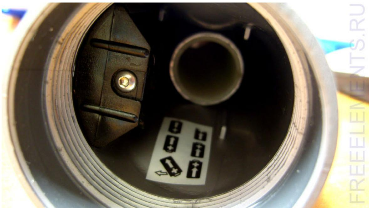
Установка первой проставки, переходника для аккумулятора 18650, имеет некоторые особенности. Кто хорошо знаком с этим подводным фонарем, знает, что сначала устанавливается ряд батареек, которые контактируют с контактом выключателя.
