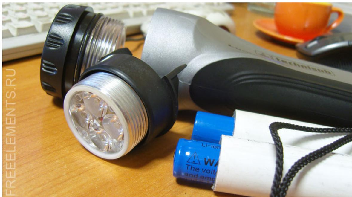
Модернизированная вставка Lumen Led Head Li в своей конструкции имеет специализированный драйвер питания для использования только с Li аккумуляторами 18650 и четыре сверхмощных светодиода.
