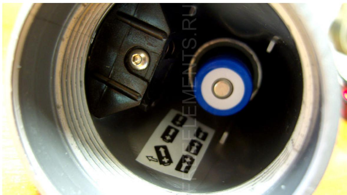
Далее в нее устанавливаются два литиевых аккумулятора 18650 и вся конструкция возвращается на прежнее место, аккумуляторы входят в контакт с контактной площадкой выключателя.
