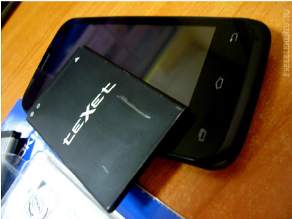
Владельцы смартфона ТЕХЕТ TM-4272 X-BASIC часто сталкиваются с одной и той же проблемой, аккумулятор смартфона Texet TM-4272 раздувается, теряет емкость и доставляет владельцу очень много неудобств, связанных с тем, что купить новый аккумулятор TM-4272 практически невозможно.
