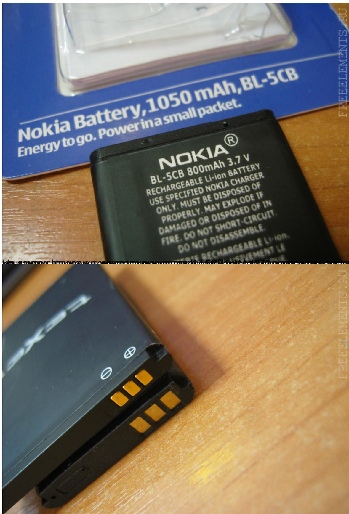
Аккумулятор для ТЕХЕТ TM-4272 x-basic, емкость 800mAh, напряжение 3.7V, модель BL-5CB, NOKIA
